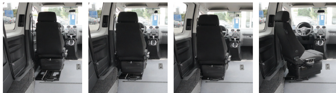
Mit dem Turny 6-Way einfach vom Rollstuhl auf den Vordersitz umsteigen. Mit den Bedienelementen positionieren
